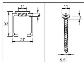
NOTA : Afin de respecter l'encombrement maximal, les têtes de vis doivent avoir un  $\varnothing$  de 11mm max et une hauteur max de 4 mm (hors fraisage). En règle générale quelque soit la tête de vis, le diamètre de celle-ci ne pourra pas être supérieur à 5,5mm
