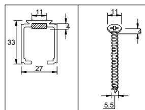
NOTA : Afin de respecter l'encombrement maximal, les têtes de vis doivent avoir un  $\varnothing$  de 11mm max et une hauteur max de 4 mm (hors fraisage). En règle générale quelque soit la tête de vis, le diamètre de celle-ci ne pourra pas être supérieur à 5,5mm
