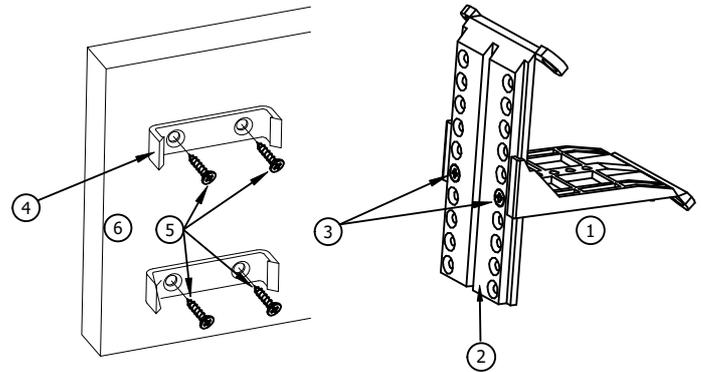
NOTA : Le bandeau (6) est fournis séparément suivant les dimensions demandées à la commande (prévoir une surcote en hauteur pour recoupe en biseau), celui-ci se positionne (voir au verso) au dessus du rail (Figure A) ou devant (Figure B) suivant l'esthétique souhaitée.
