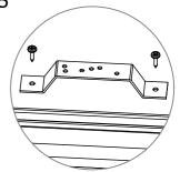
2 - Démontez les butées d'extrémité du rail (vis + rondelle), montez la poulie et repositionnez
