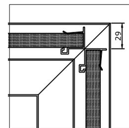
Ces implantations nécessitent de définir une cote de largeur précise et d'appliquer une surcote (pour une découpe à 45°) aux rails haut et bas en fonction de l'aménagement.
