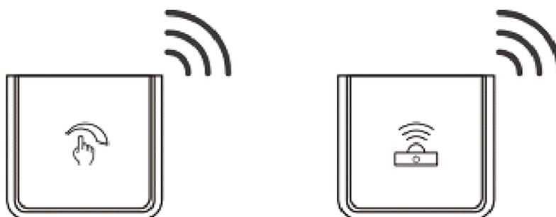
**4.6 Désynchroniser la télécommande :** Appuyez sur le bouton interne de la télécommande pendant 2 secondes. La lumière clignotera et se désynchronisera
