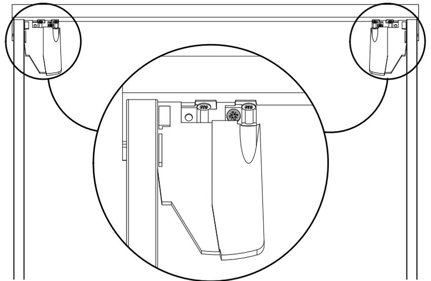
**7** EN OPTION : Si largeur module > 600mm Mettre en place une équerre de renfort au centre
