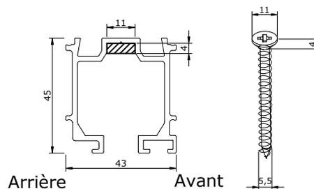
NOTA : Afin de respecter l'encombrement maximal, les têtes de vis doivent avoir un  $\varnothing$  de 11mm max et une hauteur max de 4 mm (hors fraisage).
