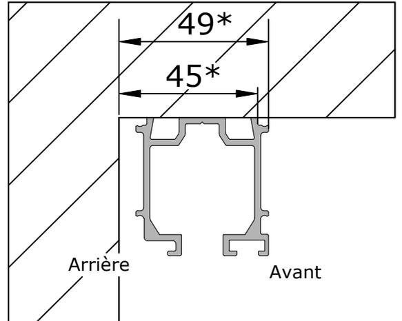
\* Si présence de plinthe, additionnez l'épaisseur de plinthe à 49
