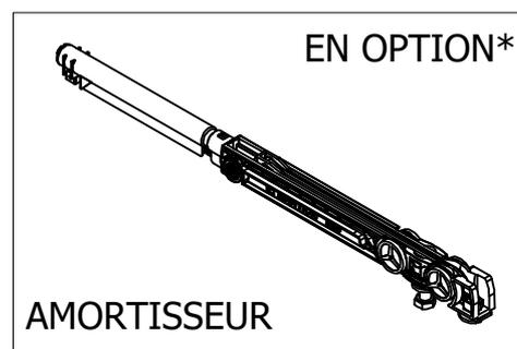
Largeur minimum du vantail pour 1 amortisseur : 620mm
