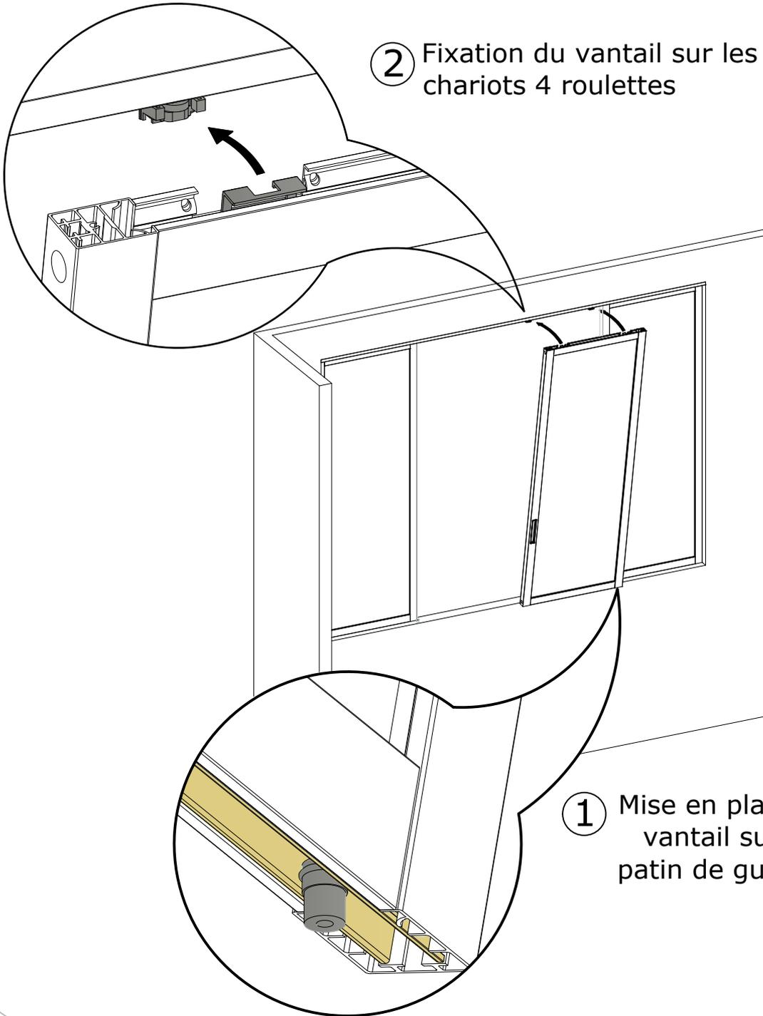
① Mise en place du vantail sur le patin de guidage
