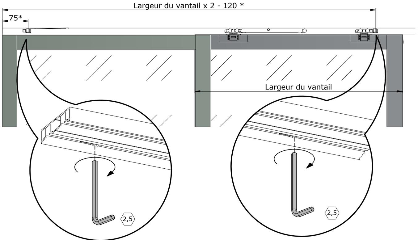
\* Les cotes sont théoriques, ne pas hésiter à ajuster les positions des butées et déclencheurs amortisseurs pour un fonctionnement optimal
