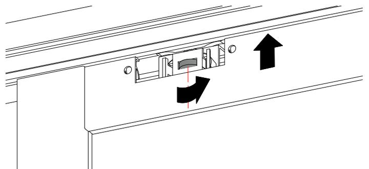
Tourner la molette vers la droite permet de monter le vantail
