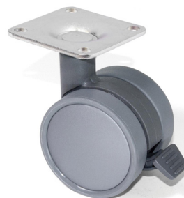
Roulette avec frein, finition aluminium, H73 mm, Ø 50 mm (y-compris plaque et vis)
